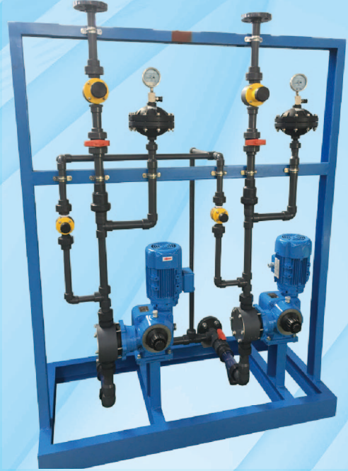
两台泵2个出口配置，单独往不同的系统加药
