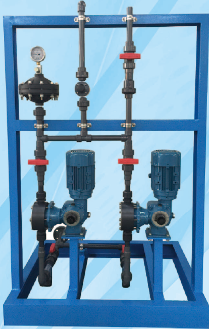
两台一用一备的情况也可以如图共用一套缓冲器、安全阀和背压阀，可以降低设备成本。
